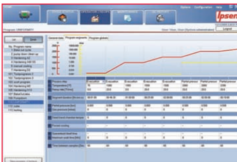
PANTALLA DE GENERACIÓN DE RECETAS Y CONTROL DEL TITÁN
